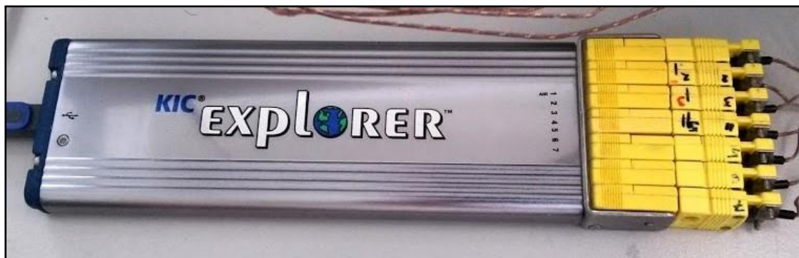
Obr. 6.1.2 – KIC EXPLORER – snímač teplotního profilu
